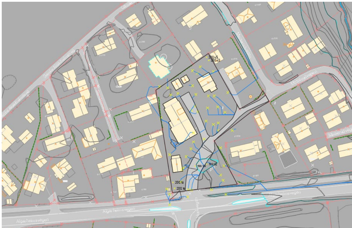
Figur 12 - Drenslinjer dagens situasjon. AutoCAD
