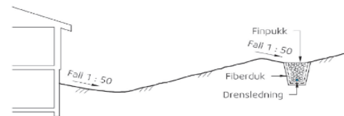
Figur 11 - Eksempel avskjærende grøft
