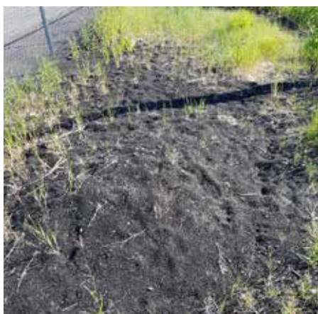
Bilde 112, 113 og 114: Bilder av granulat utenfor banen og granulat som har fulgt med overvannet (til høyre).
