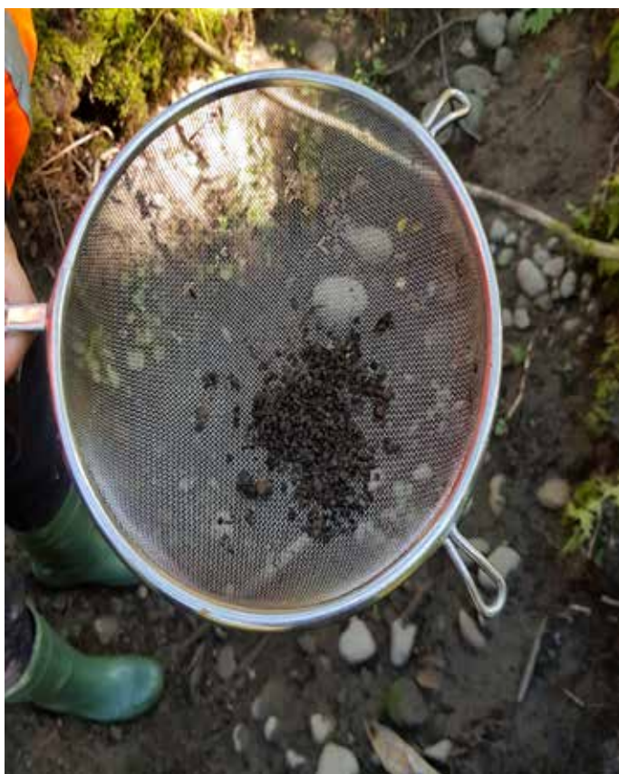
Bilde 158 og 159. Ved befaring ble det funnet granulat i et skogsholt der overvannet fra banen kom ut. Det strakk seg ett godt stykke inn over i skogen, og det var et lag på minst et par cm. med granulat.
