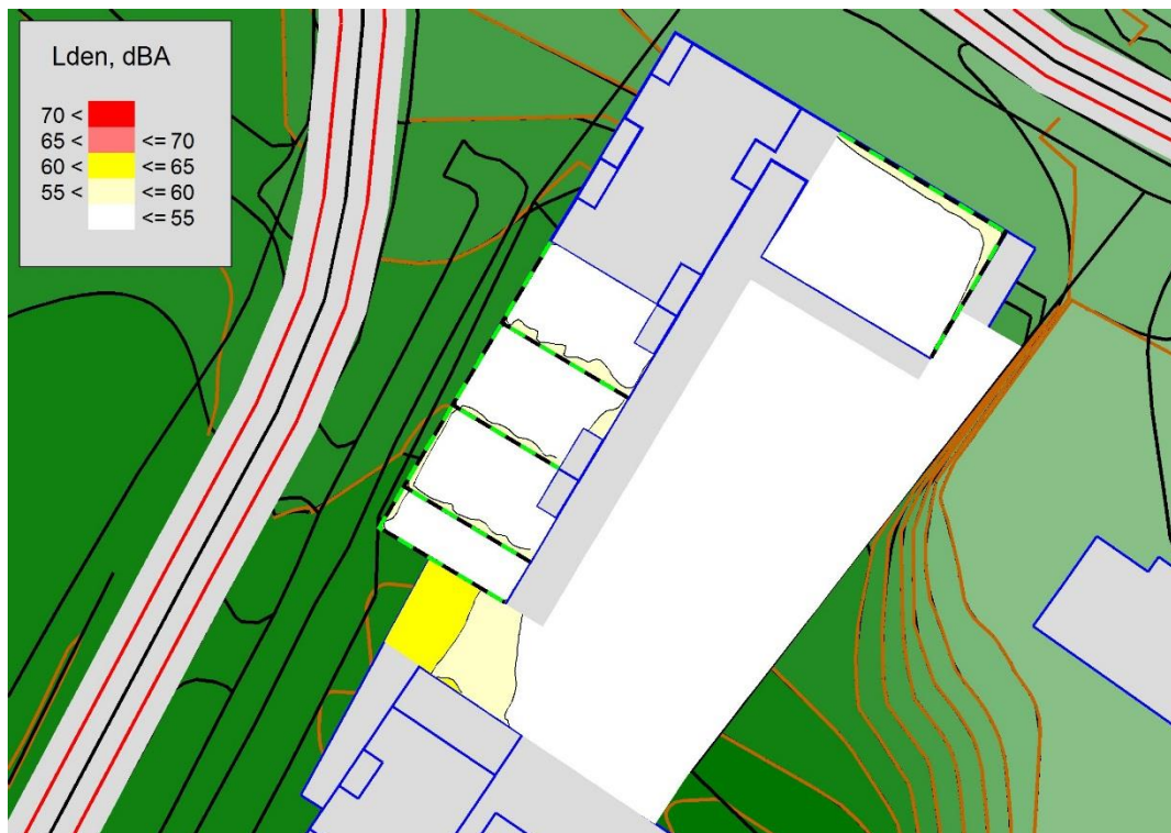
Figur 3. Beregnet ekvivalent støynivå fra veitrafikk ved høyde 1,5 meter over terreng på bakke og terrasser. Gul farge viser støynivå L_{den} > 55 dB. Hvit farge viser støynivå L_{den} < 55 dB. Minste høyder på skjermer på terrasser er definert i tekst.
