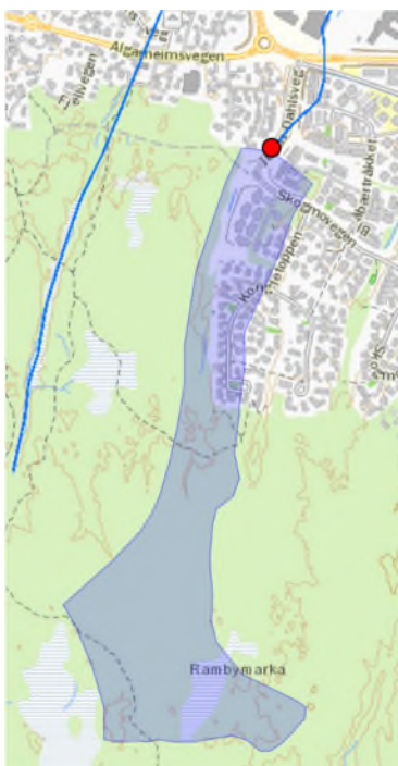
Figur 4. Nedbør-/avrenningsfeltet til felt 3-1 og 3-2; fra bruk av programmet NEVINA etter noen korrigeringer av feltgrensen.
