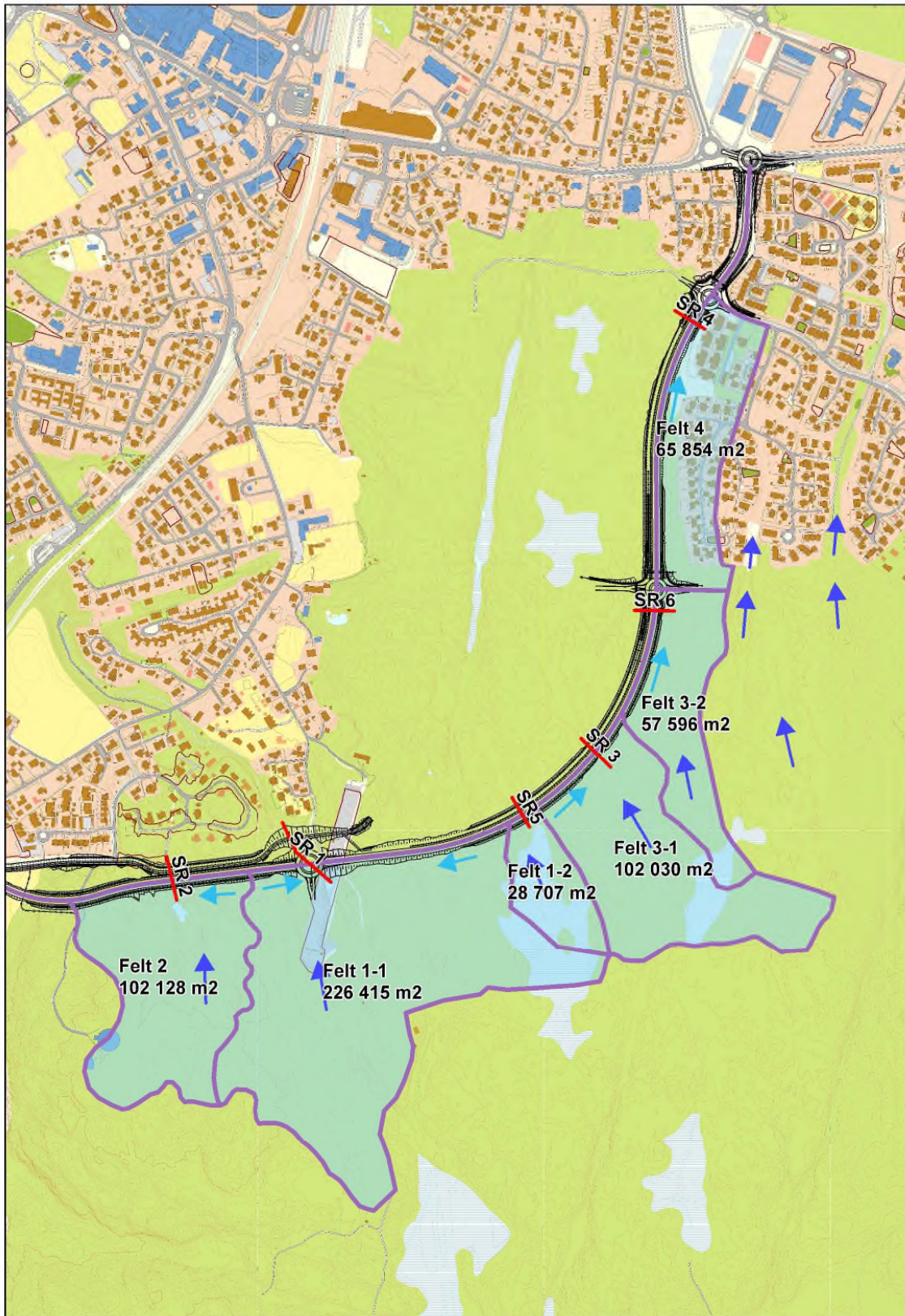
Figur 8 viser plassering av stikkrenner og antatte avrenningsfelt, med arealangivelse i tillegg.
