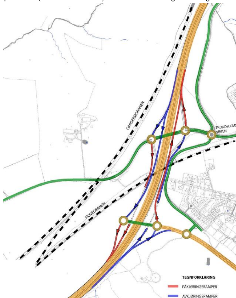
Figur 3: Skisse til fremtidig løsning for omkjøringsveg og utvidet E6. Hentet fra Asplan Viaks rapport.
