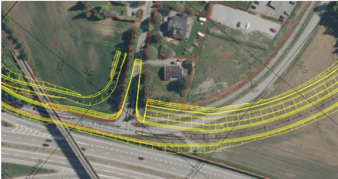
Figur 6: Foreløpig prosjektering av 2-felts omkjøringsveg med GS-veg. Kryssløsning mot Langelandsfjellet er ikke vist. Norconsult.
