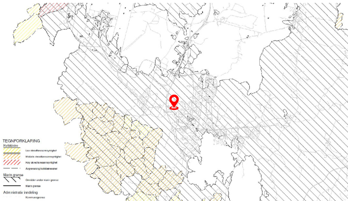
Figur 8 Utsnitt fra kommuneplanens temakart om kvikkleire og marin grense. Eiendommens posisjon er tegnet inn med rød posisjonsmarkør. Kartet viser at eiendommen ikke er utsatt for skred, men ligger under marin grense og dermed har behov for geoteknisk vurdering.
