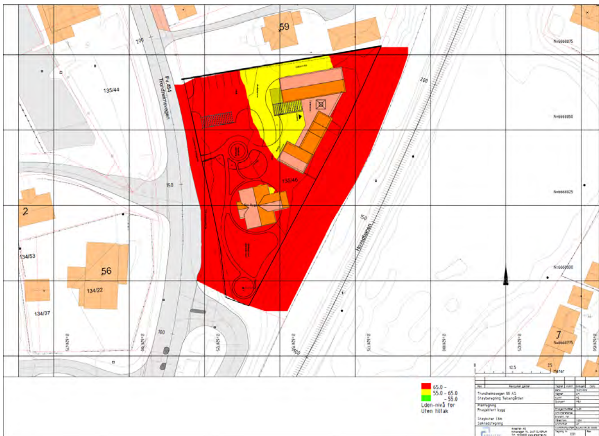
Figur 5. Støysonekart 1,5 meter over terreng. Dagens trafikksituasjon.
