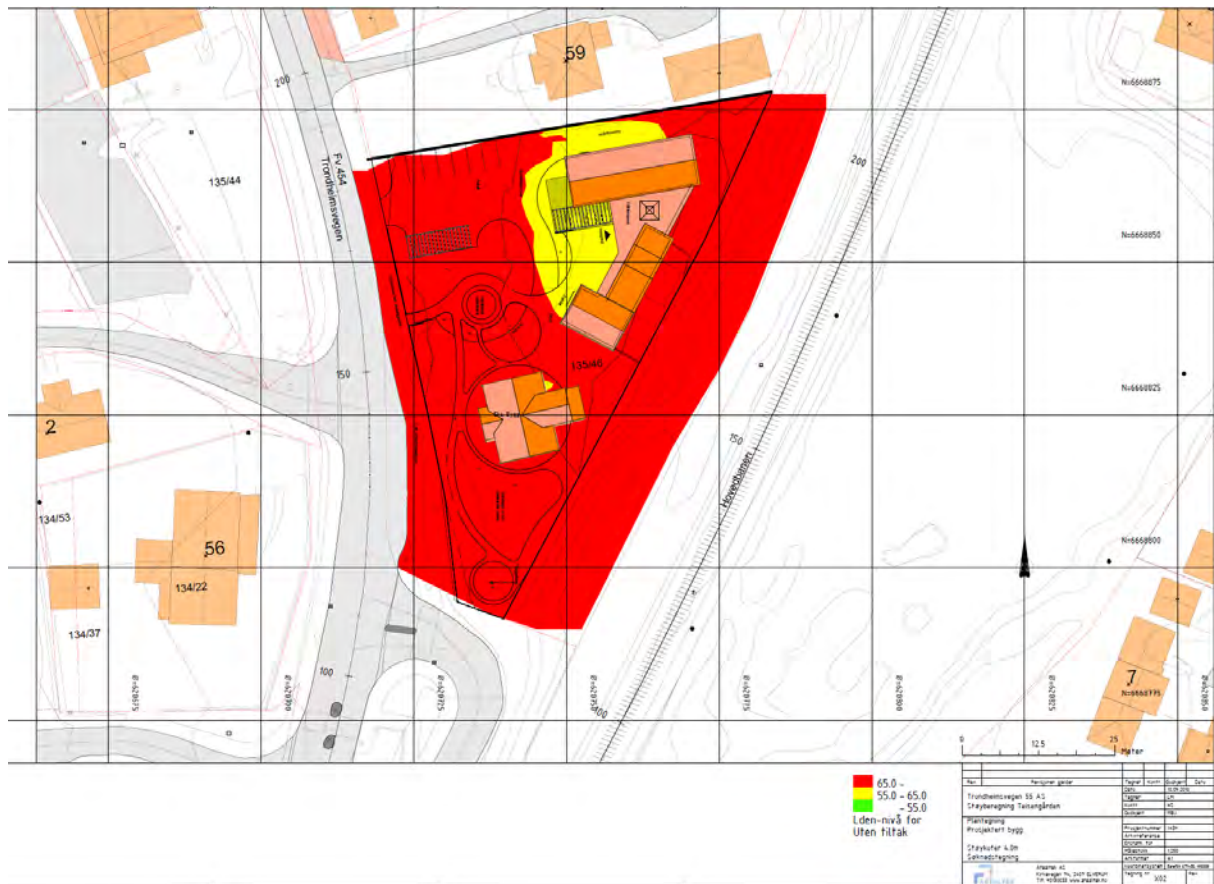
Figur 6. Støysonekart 4 meter over terreng. Dagens trafikksituasjon.
