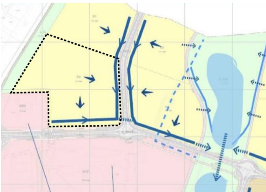
Figur 5: Forslått trase for flomvann og vannveier. Illustrasjon utarbeidet av COWI, på vegne av Ullensaker kommune.
