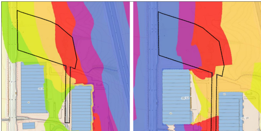
Figur 4: Støykart som viser hvordan støy fra hhv. E6 (til venstre) og jernbanen (til høyre) påvirker planområdet.
