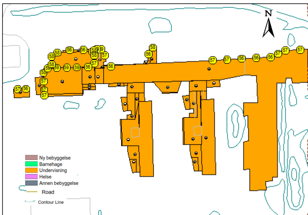
Figur 4-5: Fasadenivå for Gystadmarka skole ved utbygging av planområdet. Høyeste fasadenivå av L_{DEN} uavhengig av etasje.
