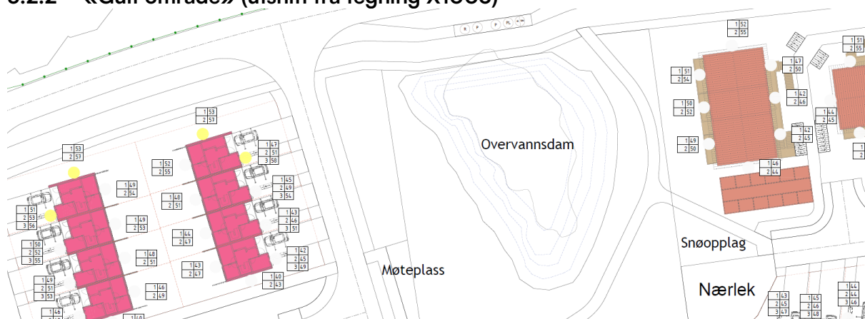
Figur 12. Fasader med støynivå L_{den} > 55 dB ved en eller flere av etasjene innenfor «gult område»
