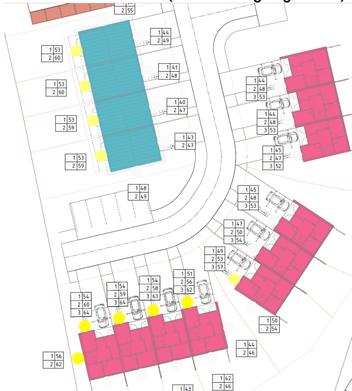
Figur 14. Fasader med støynivå L_{den} > 55\text{dB} ved en eller flere av etasjene innenfor «blått område»
