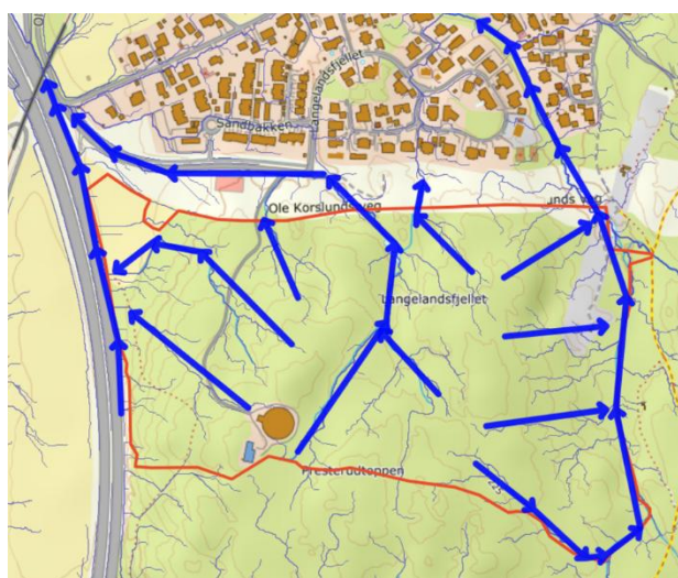
Figur 35 — Skjemdump fra Scalgo Live som viser eksisterende avrenningslinjer. Kilde: Scalgo Live/Envidan
