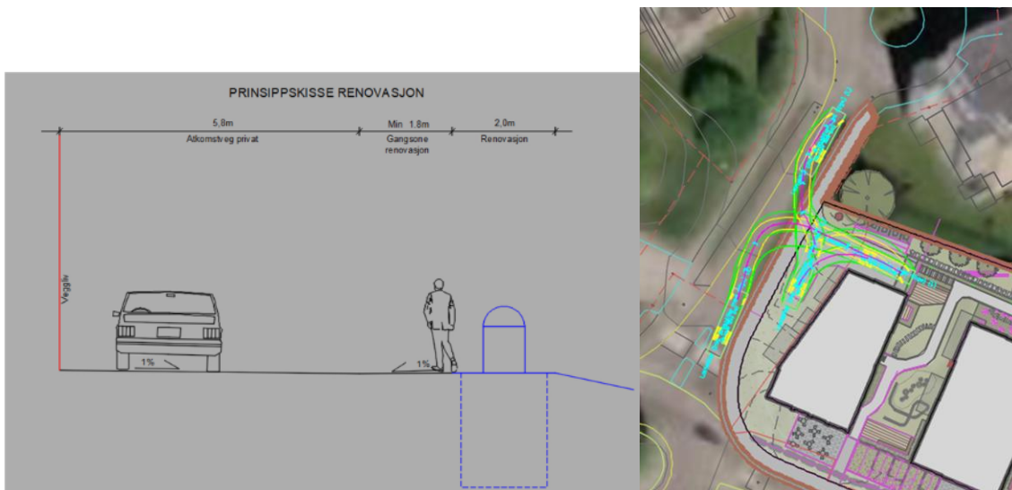
Figur 10. Skisse renovasjon og sporing av renovasjonsbil
