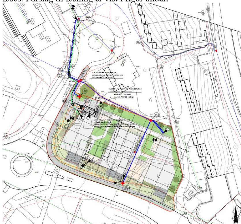
Figur 25. Foreslått løsning for nytt ledningsnett og kummer
