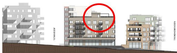
Heisoppbygg- mindre forskyvning til fasade
